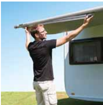
1 Das gleichzeitige Ausschwenken der Stützfüße und Spannarme
